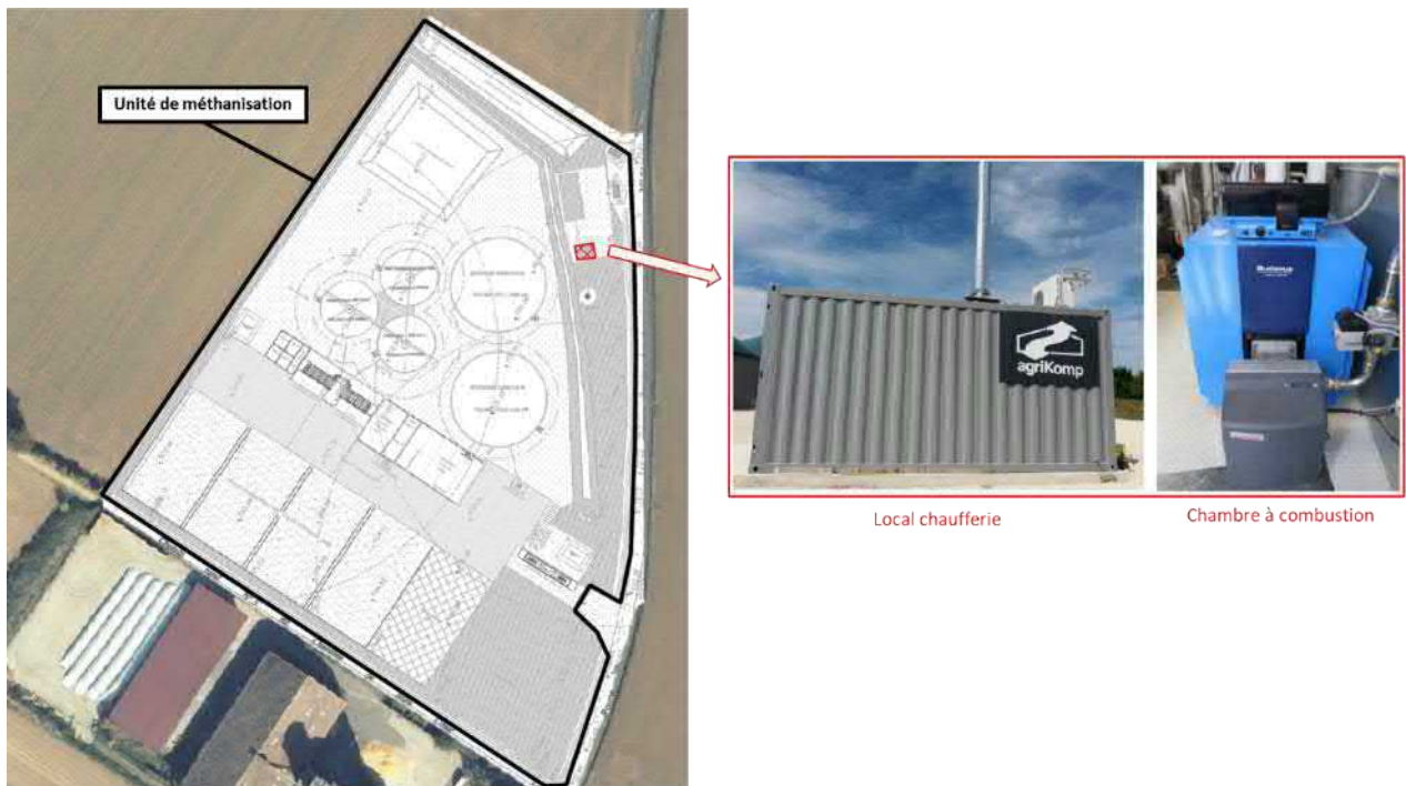
Figure 46. Localisation de la chaufferie sur l'unité de méthanisation
