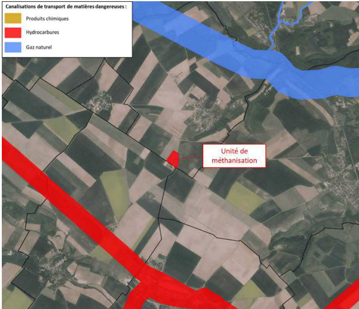
Figure 29. Réseau canalisation de transport à proximité de l'unité de méthanisation [Géorisques]
